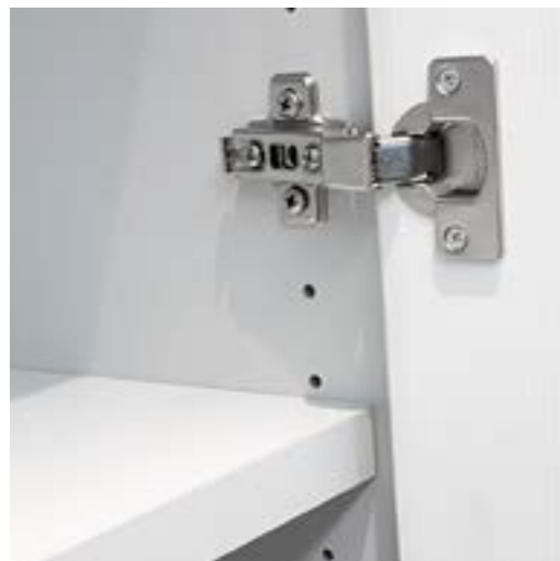
Ripiano in conglomerato legno sp 25 mm. AR1 cm 50, AR2 cm 100. Pannello laterale forato con passo 32 mm. Cerniera 110° standard, 180° a richiesta.
